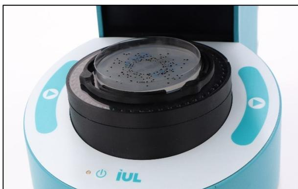
Tras pulsar el botón, la esfera difusora (2) descenderá hasta cubrir la placa de Petri, se realizarán los procedimientos de iluminación y adquisición de imágenes y, por último, la esfera difusora volverá a su posición superior de reposo. A continuación, se mostrarán los resultados del proceso en la pantalla.
