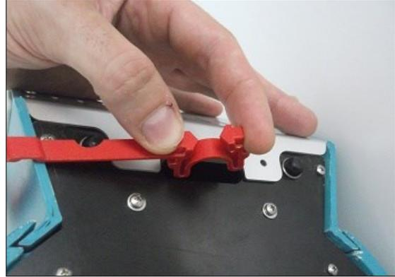
Una vez extraído, guarde el dispositivo de sujeción para reutilizarlo en futuros envíos, ya que es esencial para el transporte Seguro del SphereFlash®.
